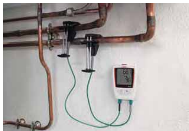
TST 220 dotato di due sensori a termocoppia a clip per il controllo della rete di acqua calda sanitaria (ACS), montato su una piastra a muro
